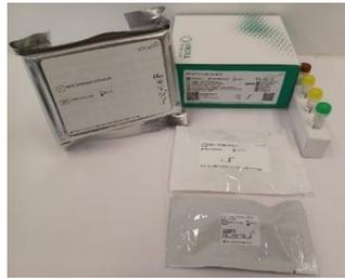
**RTPCR016-LPD:** 1 placa PCR divisible de 96 pocillos con Master Mix liofilizada predispensada que se puede separar fácilmente en 12 tiras de 8 tubos. Los usuarios pueden separar las tiras necesarias para la carrera y almacenar el resto de ellas sin afectar a la fecha de caducidad.
